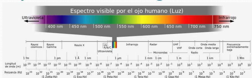
La luz visible está formada por radiación electromagnética cuyas longitudes de onda están comprendidas entre ~ 400 y 700 nm
